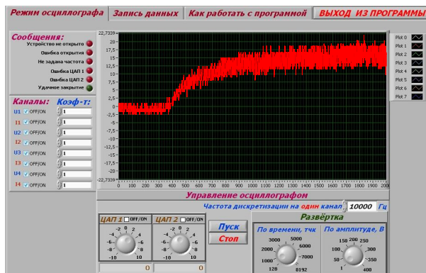
Рисунок 4 – Вікно програми роботи з модулем ЦАП–АЦП mDAQ в «режимі осцилографа»
