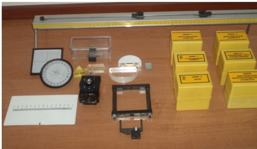
Рисунок 2 – Загальний вигляд комплекту приладів «Оптична міні-лава»
